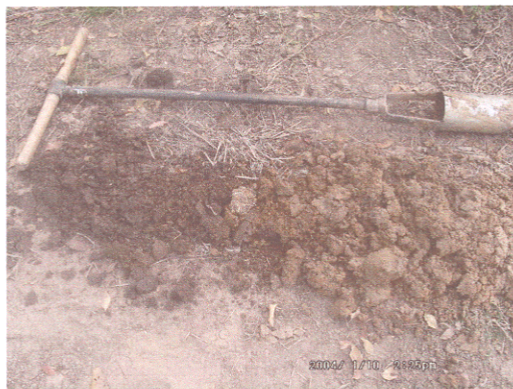
รูปที่ 3.21 ส่วนมือ (Hand Auger)
