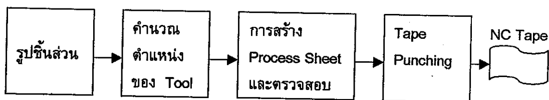
รูป 2.14.1 ขั้นตอนการสร้างเทปโดยการ Programming แบบ Manual
