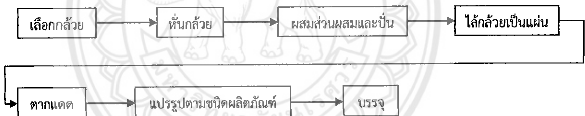
รูปที่ 1.1 กระบวนการผลิตผลิตภัณฑ์กล้วยแปรรูป
