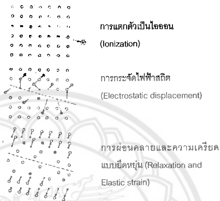
ภาพ 5 แสดงการเกิดรอยของอนุภาคบนวัสดุ เมื่ออนุภาคมีพลังงานจลน์ต่างๆ กัน [9]
