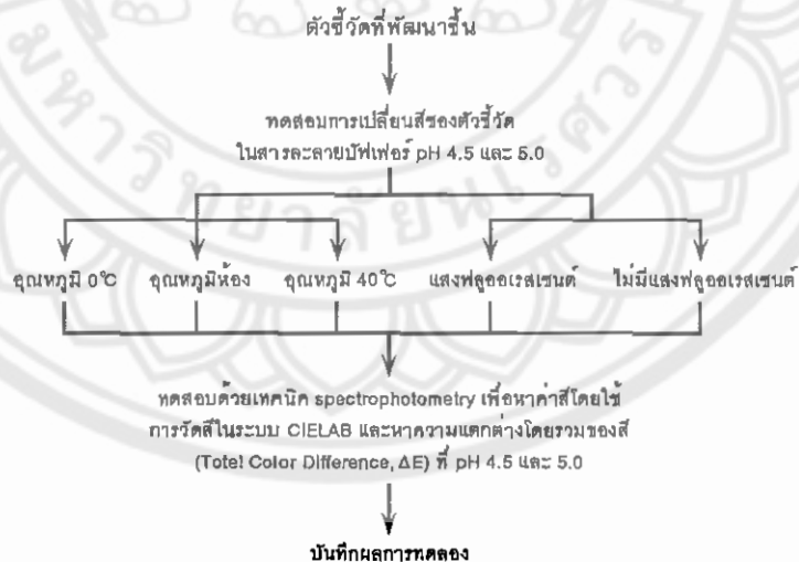
ภาพ 25 แผนผังการศึกษาความเสถียรของสีของตัวชี้วัดที่พัฒนาขึ้น
