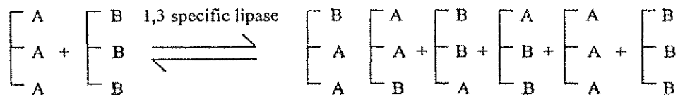
ภาพ 5 ปฏิกริยา Ester-ester interchange ระหว่างไตรกลีเซอไรด์กับไตรกลีเซอไรด์
