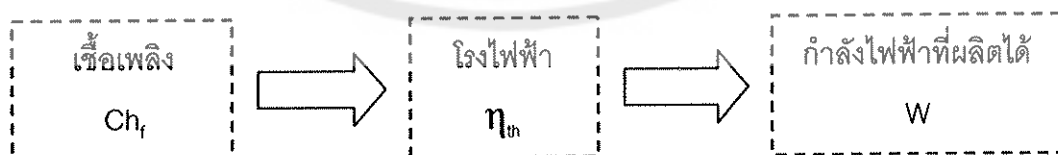
ภาพ 10 ไดอะแกรมสมดุลพลังงานของโรงไฟฟ้า
