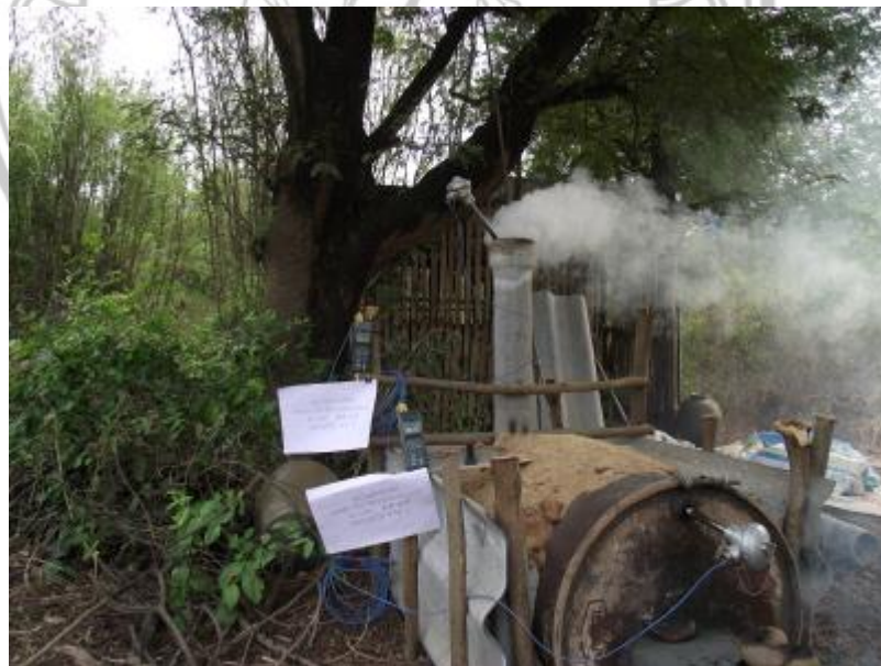
ภาพ 8 การติดตั้งเครื่องมือวัดอุณหภูมิความร้อนภายในเตาเผาถ่านไม้ และที่ปากปล่องเตาเผาถ่านไม้ขนาด 200 ลิตร ชนิดแบบแนวนอน
