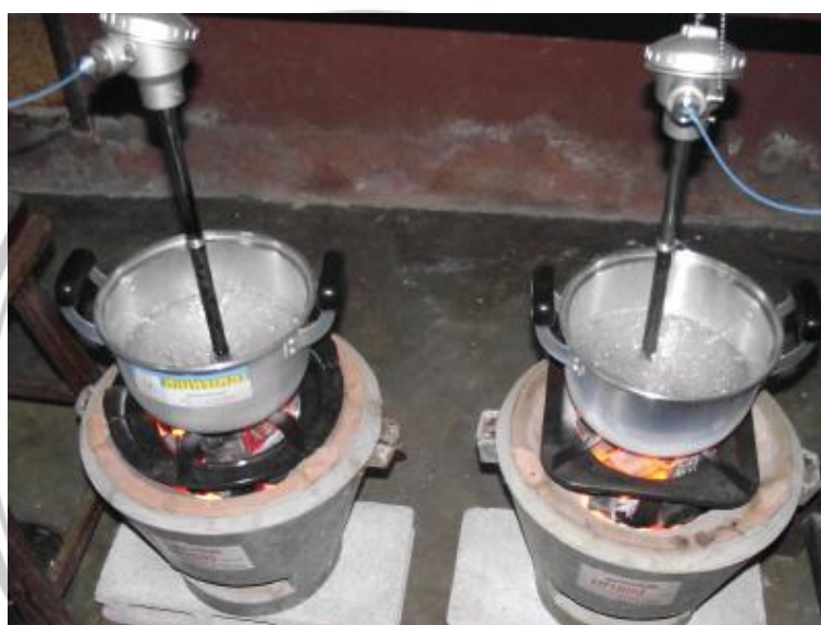
ภาพ 10 การติดตั้งเครื่องมือวัดอุณหภูมิความร้อนเพื่อทดสอบประสิทธิภาพของถ่านไม้ที่ได้จากเตาเผาถ่านไม้ขนาด 200 ลิตร ชนิดแบบแนวนอนกับแบบแนวตั้ง
