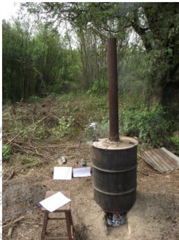
ภาพ 9 แสดงการติดตั้งเครื่องมือวัดอุณหภูมิความร้อนภายในเตาเผาถ่านไม้ และที่ปากปล่องเตาเผาถ่านไม้ขนาด 200 ลิตร ชนิดแบบแนวตั้ง
