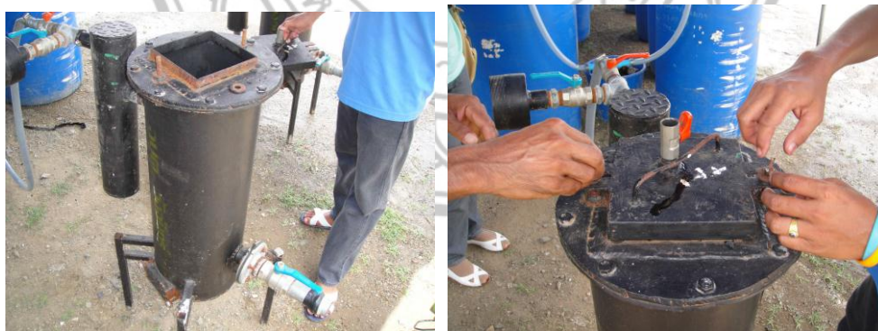
ภาพ 27 การติดตั้งเตาผลิตก๊าซชีวมวลแบบอากาศไหลลง
