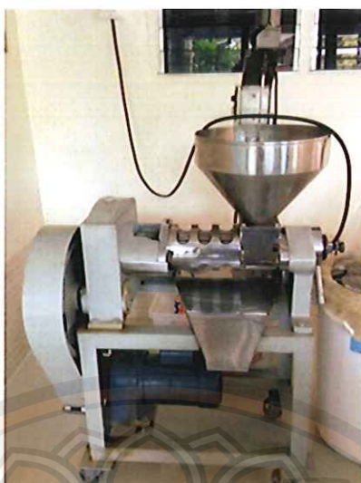
ภาพ 7 เครื่องบีบน้ำมันรำข้าวบีบเย็นแบบเกลียว ขนาด 2 แรงม้า
