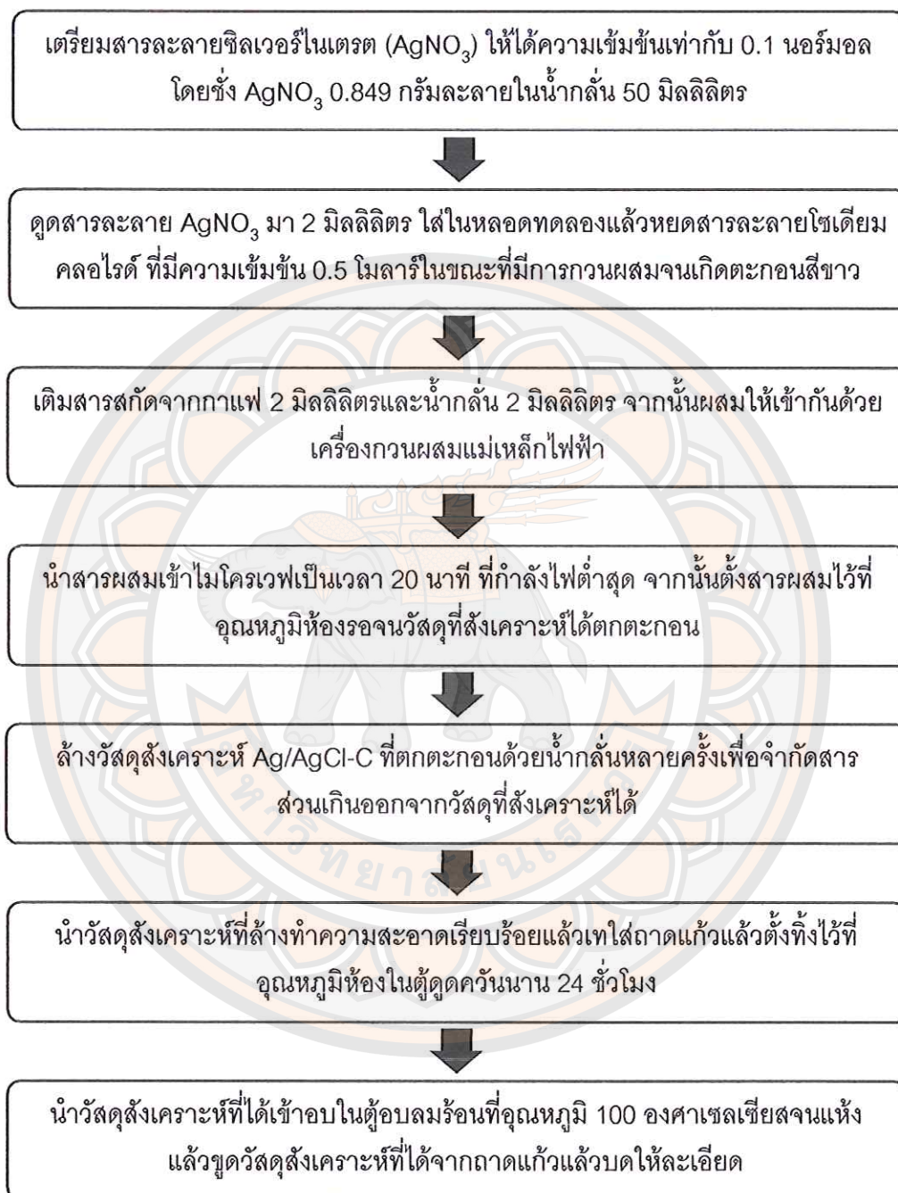
ภาพ 19 แสดงขั้นตอนการสังเคราะห์ Ag/AgCl-C
