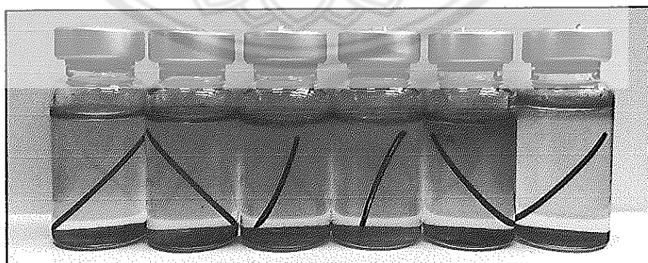
ภาพ 93 ผลการหาปริมาณแบคทีเรีย SRB หลังการบำบัดด้วยวิธี EF โดยใช้ชีวอาโนดและคาโทดเป็น BDD
