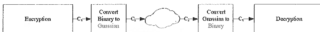
ภาพ 9 วิธีการส่งรหัสลับจำนวนเต็มแบบเกาส์เซียนไปยังช่องสัญญาณ
