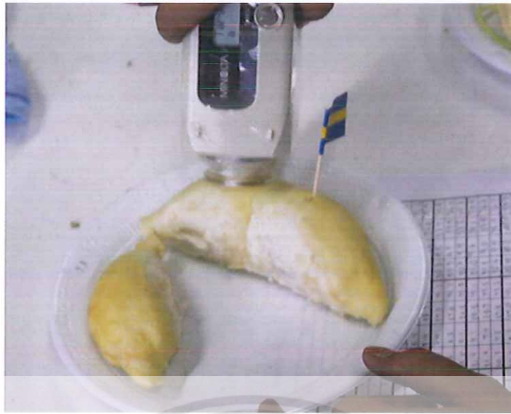
ภาพที่ 6 การวัดค่าสีเนื้อทุเรียนในระบบ CIELAB โดยใช้เครื่องวัดสี Minolta
