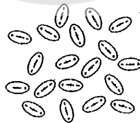
รูปที่ 11 ลักษณะของขั้วคู่ที่วางทิศทางอย่างไม่เป็นระเบียบ [20]
