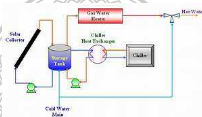
ภาพ 13 ระบบวงจรของเครื่องทำน้ำร้อนจากความร้อนเหลือทิ้งของเครื่องปรับอากาศและเครื่องทำความเย็น
